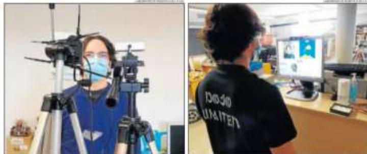
El sistema en proves a l'entrada del laboratori de Robòtica per identificar la persona que entra i verifica-ne la temperatura.
